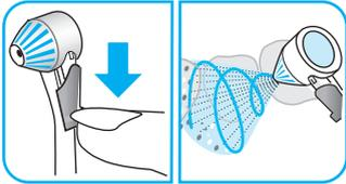
Um die Funktion der umschaltbaren Aufsteckdüse sicherzustellen, befindet sich im unteren Bereich des Schafts ein kleines Sieb. Wenn der Wasserdruck nachlässt, sollten Sie das Sieb überprüfen und eventuelle Ablagerungen entfernen, z.B. indem Sie den Schaft ausklopfen.
