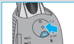
Hat die Station eines der drei Reinigungsprogramme gewählt, wird sie erst beginnen, wenn Sie die Start-Taste ④ drücken. **Für beste Rasur-Ergebnisse empfehlen wir, nach jeder Rasur zu reinigen.**
