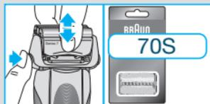
Wenn Sie das Schersystem gewechselt haben, drücken Sie die Reset-Taste
